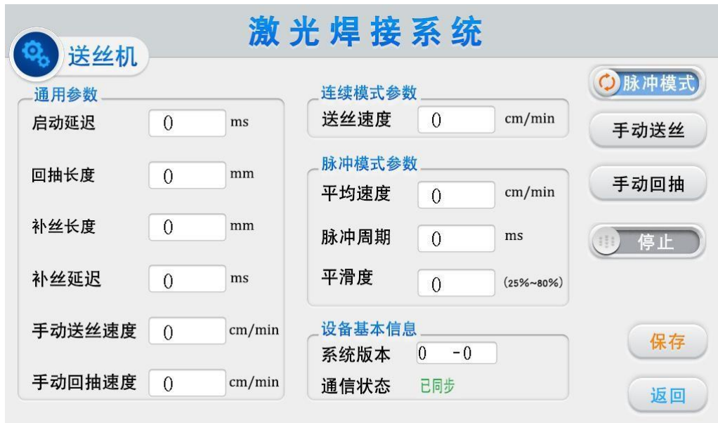
图 4.12 工艺库-送丝机参数
