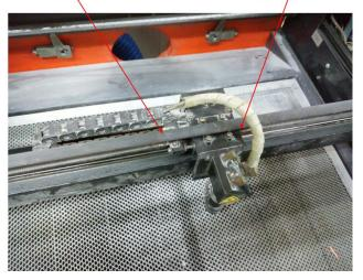
ベルトバンド側を取り付けたら、ベルトのテンションを調整します。テンションはナット間の距離で調整します。
