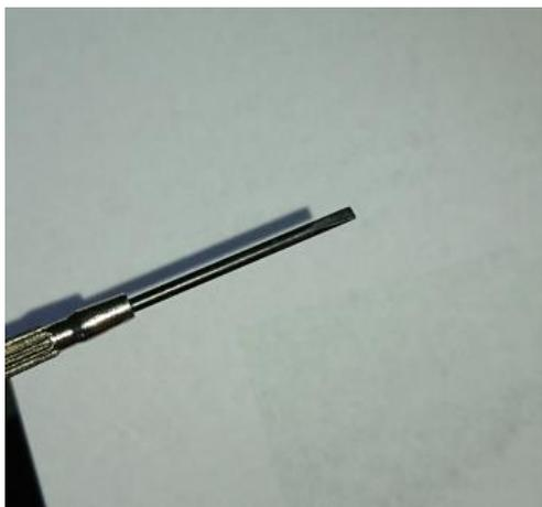
精密ドライバーでピンの返し部分を抑え、配線を抜き取ります。ピンの返しを強く押さえすぎるとピンが変形してしまうので、力加減に注意してください。
