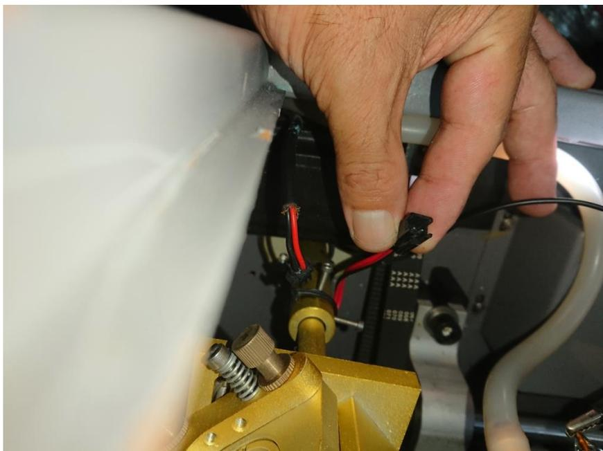
配線の入替えは、コネクタのピンを抜いてはめ替えますが、レッドポインター側のコネクタのピン(オス)は専用の引き抜き工具が無いと取り外すことが難しいので、配線側のコネクタのピンを抜いて、はめ替えます。
